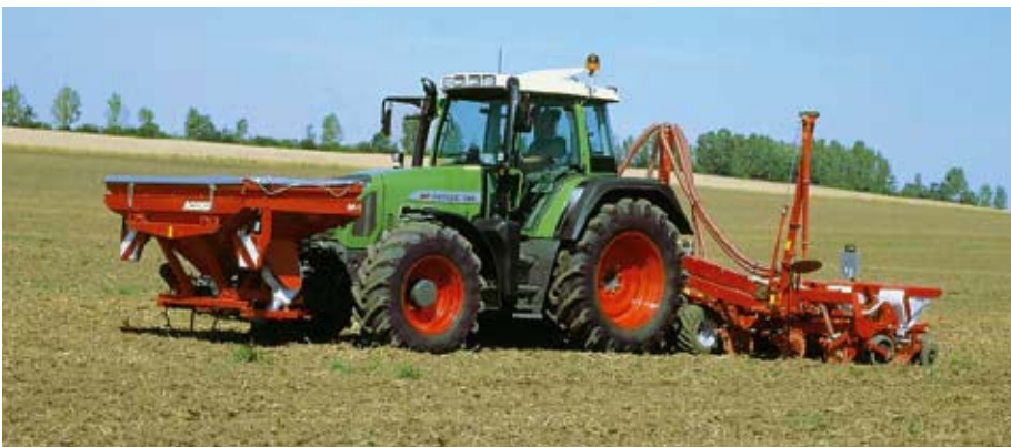
Fendt Vario 716 TMS mit Düngestreuer vorne und Einzelkornsähergerät hinten
